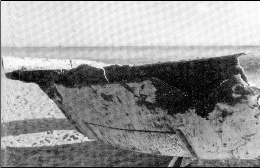
Ansicht des auf dem Kopf liegenden Kajütdachs von vorne. Die Verbindung zum Deck ist glatt abgerissen. (Foto: Fred Steppat, Bearb.: J. Bruhn).
