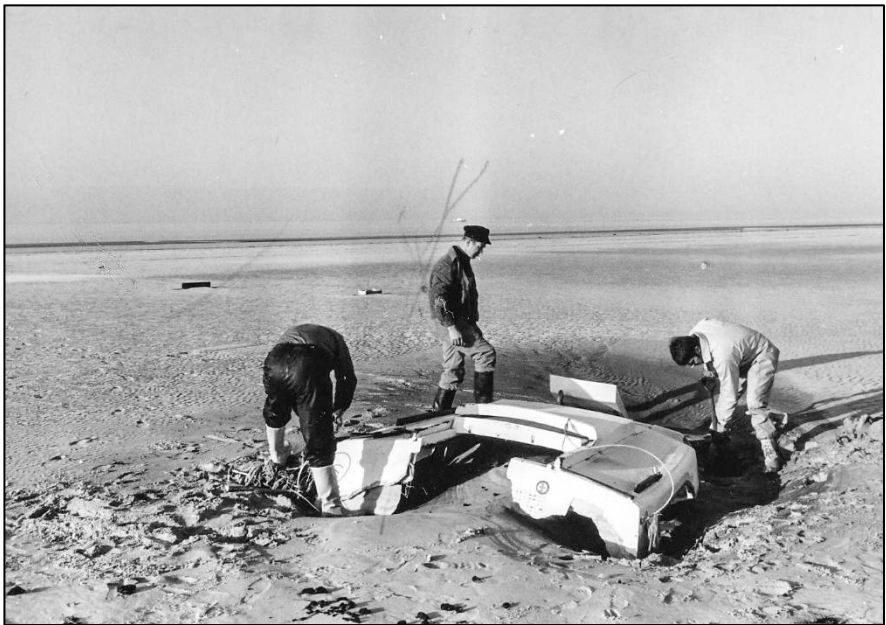
Noch einmal das eingesandete Kajütdach mit den Seitenwänden. Deutlich zu sehen ist das zerstörte Schott zur Plicht. (Foto: Fred Steppat, Bearb: J.Bruhn).
