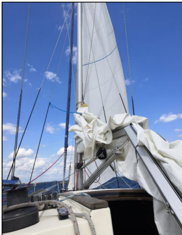
Der gebrochene Großbaum.
